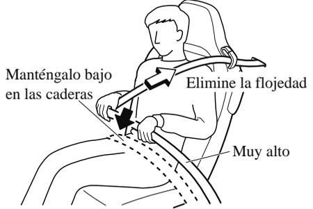
Antes de fijar el cinturón de seguridad, asegúrese de que el cinturón de seguridad pase correctamente por la guía del cinturón de seguridad y que no esté retorcido.
