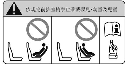
Incluso en caso de un choque moderado, el sistema de seguridad para niños puede ser golpeado al inflarse un airbag y se puede desplazar violentamente hacia atrás provocando en heridas graves o la muerte del niño. Si su vehículo está equipado con un sistema de clasificación de ocupantes, siempre asegúrese que el indicador de desactivación de la bolsa de aire del acompañante OFF está encendido, al instalar un sistema de seguridad para niños mirando hacia atrás en el asiento del acompañante.
