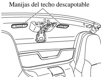
5. Sentándose en un asiento, tome las manijas del techo descapotable, y oprima el techo descapotable contra el parabrisas. Asegúrese que el cerradero se engancha con el anclaje, mueva el seguro superior lentamente, y luego empuje el seguro superior hacia arriba hasta que escuche un sonido de bloqueo.
