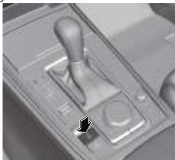
Si el interruptor del EPB se presiona sin pisar el pedal del freno, se muestra un mensaje en el visualizador de datos múltiples para notificar al conductor que debe pisar el pedal del freno. Consulte la sección Mensaje indicado en el visualizador de datos múltiples en la página 7-75.
