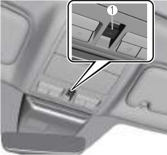
1. Interruptor de inclinación/ deslizamiento
