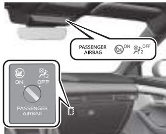
El interruptor de desactivación del airbag del pasajero debe ser usado para desactivar el airbag del pasajero y los airbags laterales, así como el sistema de pretensores del cinturón de seguridad del asiento del pasajero si se instala un sistema de seguridad para niños en el asiento del pasajero.
