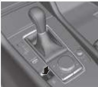
Si el interruptor del EPB se presiona sin pisar el pedal del freno, se muestra un mensaje en el visualizador de datos múltiples para notificar al conductor que debe pisar el pedal del freno. Consulte la sección Mensaje indicado en el visualizador de datos múltiples en la página 7-81.
