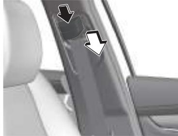
Después del ajuste, presione el ajustador del cinturón al hombro delantero hacia abajo y asegúrese de que queda bien bloqueado.
