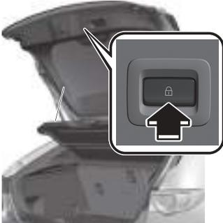
Al bloquear con el interruptor de cierre de las puertas, pulse el interruptor de cierre de las puertas cuando se cumplan todas las condiciones siguientes y, a continuación, cierre la compuerta trasera.
