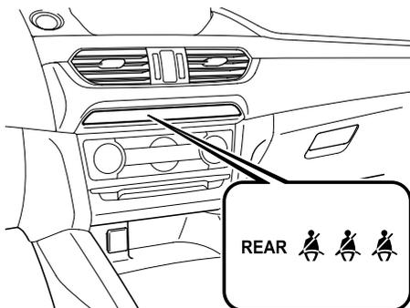
Las luces de advertencia se encenderán en dos colores. Cuando el cinturón de seguridad no esté abrochado, la luz de advertencia se encenderá de rojo. Cuando el cinturón de seguridad esté abrochado, se encenderá de verde. Las luces de advertencia funcionan incluso cuando no haya ningún pasajero sentado en el asiento trasero. La advertencia sonora solo se escuchará si un cinturón de seguridad es desabrochado luego de ser abrochado.
