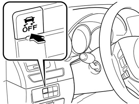
Oprima otra vez el interruptor para volver a encender el TCS/DSC. El indicador DSC OFF se apagará.
