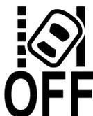
Si se continúa exhibiendo la indicación incluso después de haber usado el interruptor de sistema de asistencia de mantenimiento en carril, indica que hay un problema en el sistema. Haga inspeccionar su vehículo en un técnico experto, le recomendamos un técnico autorizado Mazda.
