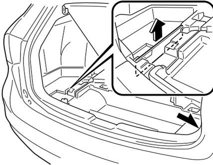
4. Guarde la cubierta del compartimiento para equipajes con las lengüetas apuntando hacia abajo.
