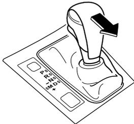
Para cambiar hacia arriba a un cambio mayor con los interruptores de cambio del volante, tire del interruptor UP (+ /OFF) hacia adelante una vez con sus dedos.
