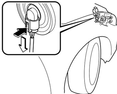
7. Gire el conector y el conjunto de la bombilla para desmontarla. Desmonte cuidadosamente la bombilla de su conector en el reflector tirando suavemente derecho hacia atrás del conector.
