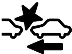
La indicación se exhibe en la exhibición de multinformación durante el funcionamiento del freno SCBS o el frenado asistido (frenado asistido SCBS).
