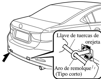
4. Enganche la cuerda de remolque en el aro de remolque.
