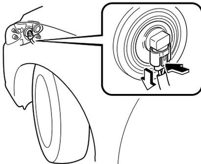
6. Gire el conector y el conjunto de la bombilla para desmontarla. Desmonte cuidadosamente la bombilla de su conector en el reflector tirando suavemente derecho hacia atrás del conector.
