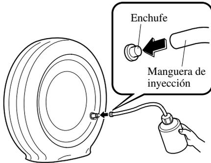
10. Sostenga la parte de abajo de la botella hacia arriba, apriete la botella con sus manos, e inyecte todo el sellador de neumático en el neumático.
