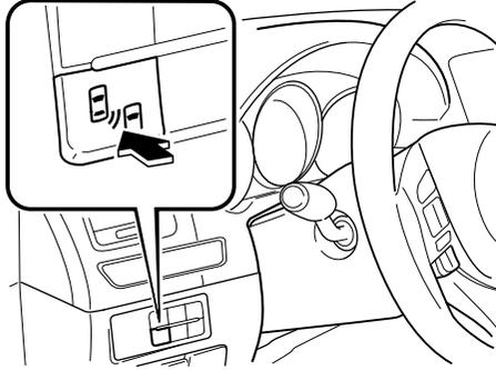
Cuando se oprime el interruptor de monitoreo de punto ciego (BSM), los sistemas de monitoreo de punto ciego (BSM) y de alerta de tránsito cruzando atrás (RCTA) se apagan y la indicación/el indicador de monitoreo de punto ciego (BSM) OFF se enciende.
