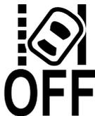
Oprima el interruptor del sistema de asistencia de mantención en carril para cancelar el sistema de asistencia de mantención en carril. Se exhibe la indicación de sistema de asistencia de mantención en carril OFF.
