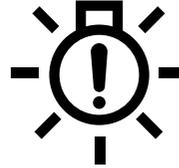
Esta luz se enciende si existe un malfuncionamiento en los faros LED. Haga inspeccionar su vehículo en un técnico experto, le recomendamos un técnico autorizado Mazda.
