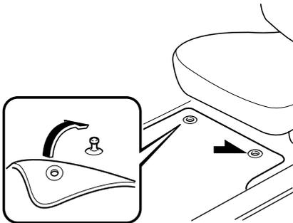
Al colocar una alfombra del piso, ubique la alfombra del piso de manera que sus arandelas o retenedores queden insertados sobre los extremos puntiagudos de los postes de retención.
