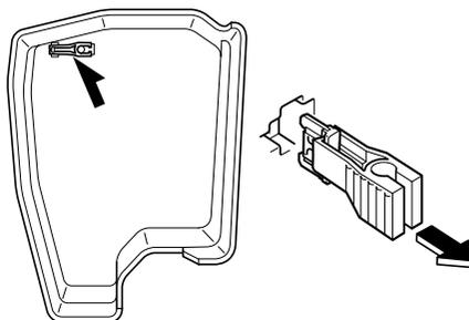
4. Inspeccione el fusible y cámbielo si está fundido.
