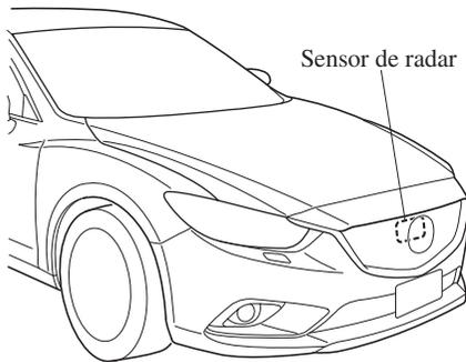
Si se exhibe el mensaje “Radar delantero bloqueado” en la exhibición de multifunción del grupo de instrumentos, limpie el área alrededor del sensor de radar (delantero).
