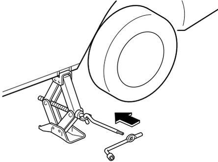
7. Gírela la manija del gato hacia la derecha y levante el vehículo lo suficientemente alto como para instalar el neumático de repuesto. Antes de quitar las tuercas de orejeta, verifique que el vehículo se encuentre en una posición estable y que no se deslice o mueva.
