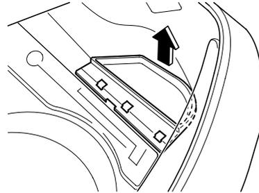
4. Tire de la sección central de cada retenedor de plástico y desmonte el retenedor y el adorno trasero del maletero.
