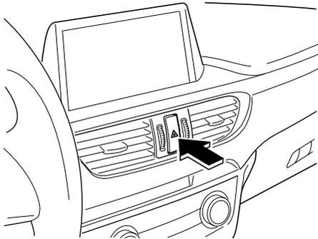
Oprima el interruptor del destellador y todas las señales de viraje, destellarán. El destellador de aviso de peligro en el grupo de instrumentos destella simultáneamente.
