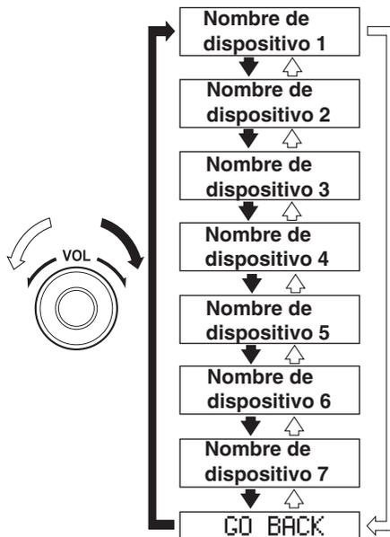
5. Oprima el dial de control de audio para seleccionar el dispositivo que desea conectar. El símbolo "♪" desaparece y "PAIRING" destella en la exhibición de audio.
