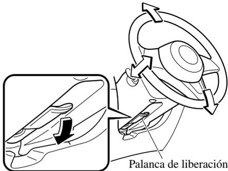
2. Incline el volante y/o ajuste el largo de la columna del volante a la posición deseada, y luego empuje la palanca hacia arriba para bloquear la columna.
