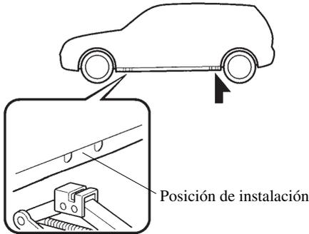
5. Continúe levantando la cabeza del gato gradualmente girando el tornillo con su mano hasta que la cabeza del gato quede insertada en la posición del gato.
