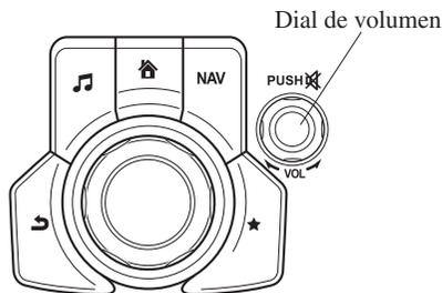
Oprima el dial de volumen para activar y desactivar el silenciamiento del audio. Gire el dial de volumen para ajustar el volumen. El volumen sube girando el dial hacia la derecha, y baja girándolo hacia la izquierda.
