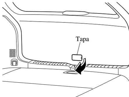
2. Gire la palanca hacia la derecha para abrir el seguro de la compuerta trasera.
