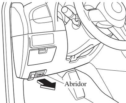
2. Inserte su mano en la abertura del capó, deslice la palanca del seguro hacia la derecha y levante el capó.
