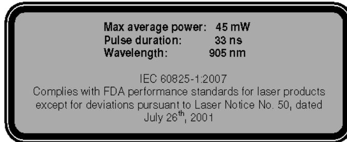
Datos de radiación del sensor láser
