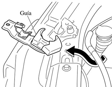
6. Desconecte el conector de la unidad presionando la lengüeta del conector con un dedo y tirando del conector hacia abajo.
