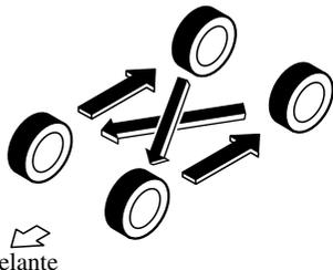
No incluya (el neumático SOLO PARA USO TEMPORARIO) en la rotación.
