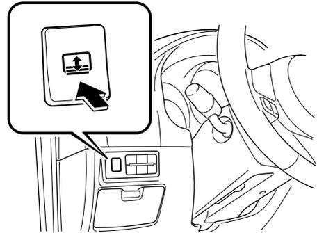
La visera trasera se levanta/baja automáticamente cuando se oprime el interruptor de la visera trasera.
