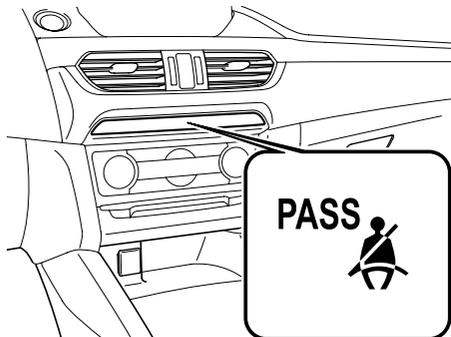
Si el asiento del conductor o el acompañante están ocupados y no se abrochan los cinturones de seguridad cuando el encendido está en ON, la luz de advertencia del cinturón de seguridad permanecerá encendida.
