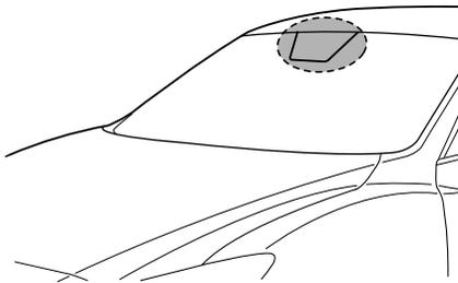
La cámara sensora hacia adelante (FSC) determina las condiciones adelante del vehículo al viajar durante la noche y detecta los carriles de tránsito. La distancia en la que la cámara sensora hacia adelante (FSC) puede detectar objetos varía dependiendo de las condiciones de alrededor.
