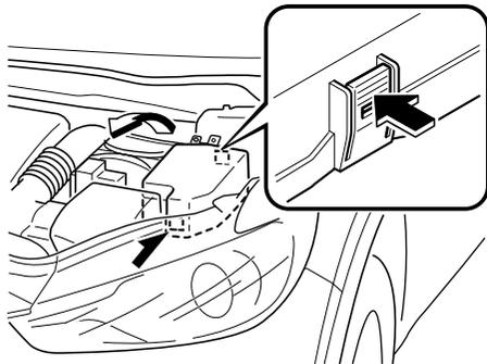
3. Si hay un fusible diferente del fusible MAIN fundido, cámbielo por uno nuevo **con las mismas especificaciones de amperaje**.
