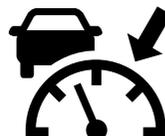
La advertencia se enciende si hay un malfuncionamiento en el sistema mientras el Control de crucero de radar de Mazda (MRCC) está encendido. Haga inspeccionar su vehículo en un técnico experto, le recomendamos un técnico autorizado Mazda.
