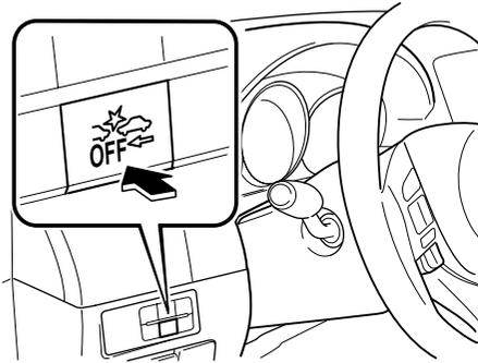
Oprima otra vez el interruptor para volver a encender el sistema. El indicador de soporte de freno de ciudad inteligente (SCBS) OFF se apagará.
