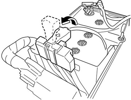
2. Debe asegurarse de que la batería de refuerzo sea de 12 V y que el terminal negativo esté conectado a masa.
