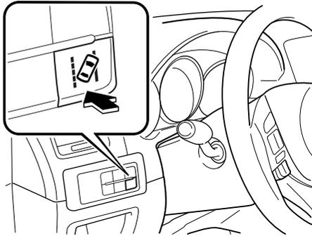
La exhibición del sistema de asistencia de mantenimiento en carril (estado de espera) aparece en la exhibición multinformación, y el sistema pasa a espera.
