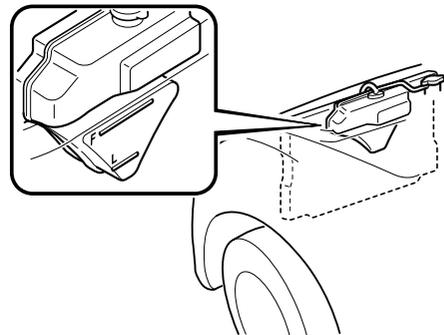
Si está en o cerca de la marca L, agregue suficiente refrigerante anticongelante y anticorrosivo en el depósito de refrigerante para llevar el nivel hasta la marca F.
