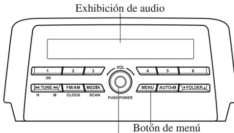
Perilla de conexión/desconexión/volumen/control de audio
