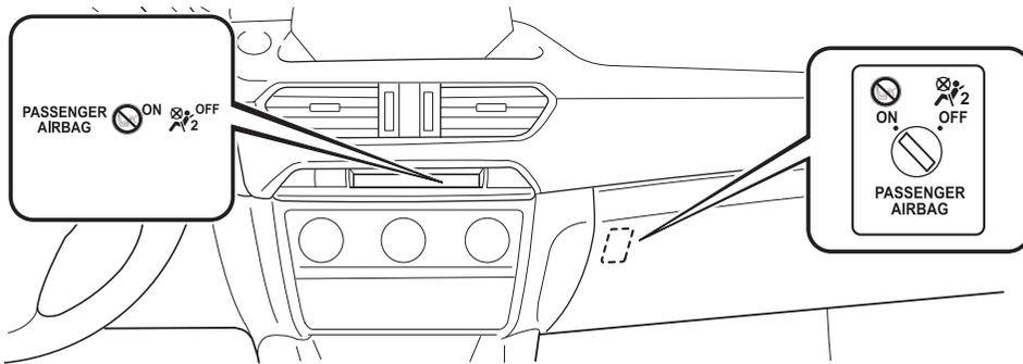
El interruptor de desactivación de la bolsa de aire del acompañante debe ser usado para desactivar la bolsa de aire del acompañante y las bolsas de aire laterales y también el sistema de pretensores del cinturón de seguridad del asiento del acompañante si se instala un sistema de seguridad para niños en el asiento del acompañante.
