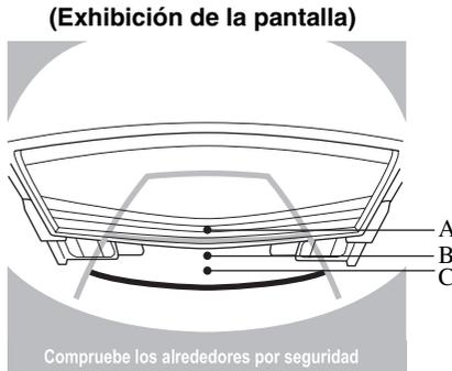
**Distancia medida mediante sensores en la pantalla  $A > B > C$**
