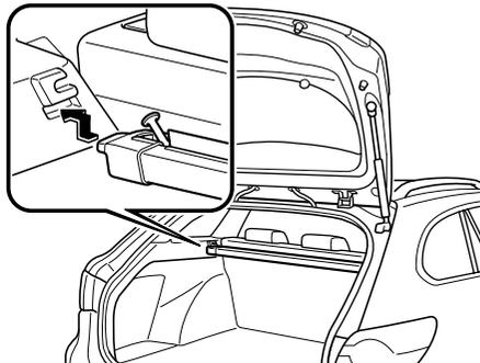
2. Retraiga el soporte de resorte de la derecha de la barra del retractor para insertarlo en la ranura de instalación.
