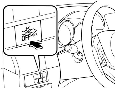
Oprima otra vez el interruptor para volver a encender el sistema. El indicador de soporte de freno de ciudad inteligente (SCBS) OFF se apagará.
