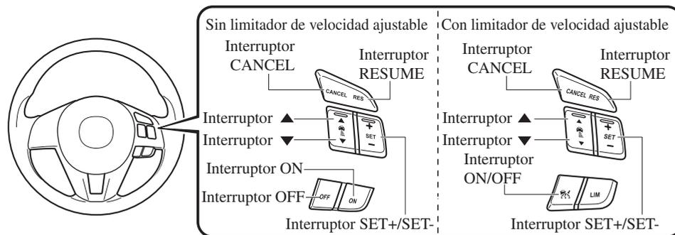
Cuando se presiona el interruptor ON, se puede ajustar la velocidad del vehículo y la distancia entre vehículos en el control de avance. La indicación de control de cruceo de radar de Mazda (MRCC) se muestra en la exhibición del grupo de instrumentos.
