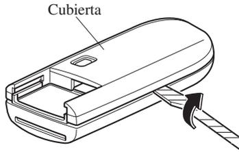
5. Retire la tapa de la pila, luego retire la pila.
