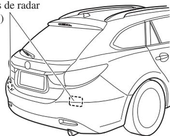
Los sensores de radar (traseros) están instalados dentro del paragolpes trasero, uno del lado izquierdo y otro del lado derecho.
