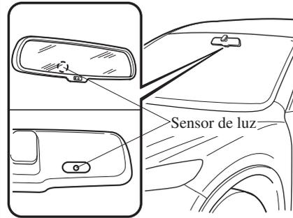
La función de atenuación automática se cancela cuando el encendido se encuentra en ON y la palanca de cambios en la posición de marcha atrás (R).
