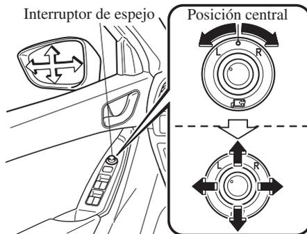
Después de ajustar el espejo, bloquee el control girando el interruptor a la posición central.
