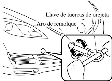
4. Enganche la cuerda de remolque en el aro de remolque.
