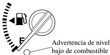
Esta luz de advertencia en el medidor de combustible indica que el tanque de combustible pronto quedará vacío. Agregue combustible tan pronto como sea posible.
