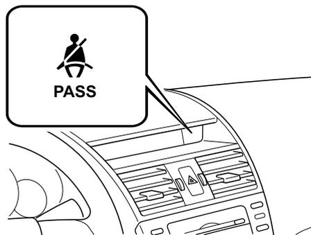
Si el cinturón de seguridad del acompañante no está abrochado y el vehículo se conduce a más de 20 km/h, destellará la luz de advertencia y se escuchará un sonido bip.
