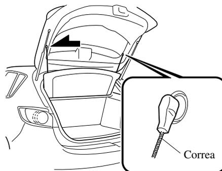
**▼ Cubierta del compartimento para equipaje (Modelo con compuerta trasera)**
