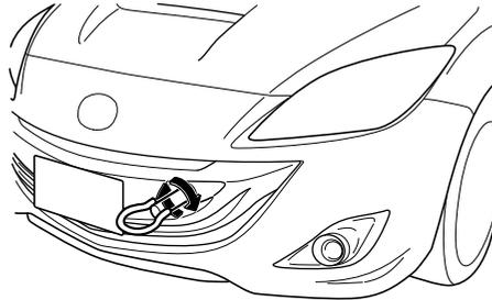
4. Instale firmemente el aro de remolque usando la llave de tuercas.
