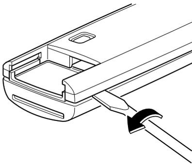
4. Retire la tapa de la pila, luego retire la pila.
