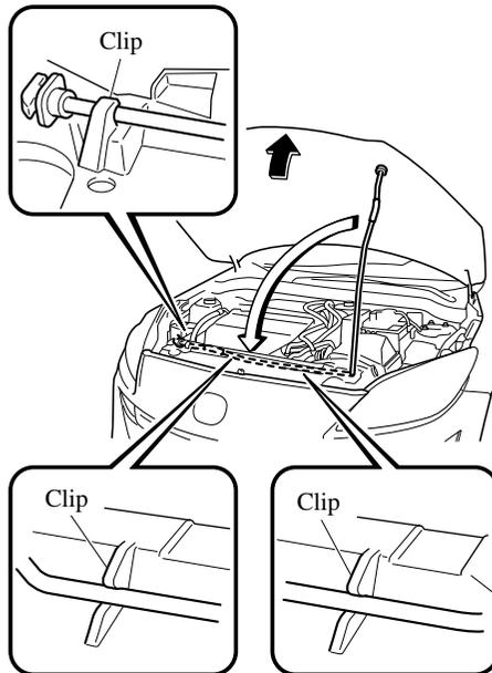
3. Baje el capó lentamente hasta que descanse en la posición de desbloqueo, y luego retire sus manos. Empuje el borde central delantero del capó hacia abajo hasta que se escuche un sonido de bloqueo, y el capó se cierre completamente.
