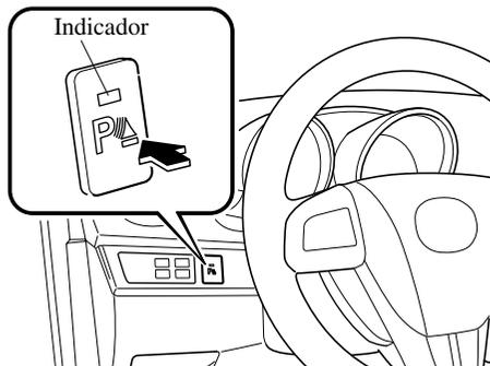
El bip se escucha y el indicador en el interruptor se enciende también cuando el encendido se cambia a ON y la palanca selectora se encuentra en marcha atrás (R) con el interruptor de sensores de asistencia de estacionamiento conectado.
