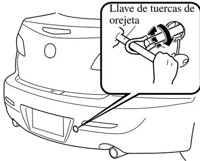
4. Enganche la cuerda de remolque en el aro de remolque.
