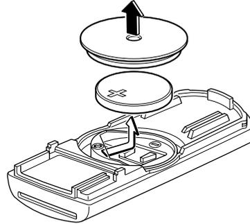
5. Inserte una pila nueva con el polo positivo hacia arriba, y luego cubra la pila con la tapa de la pila.
