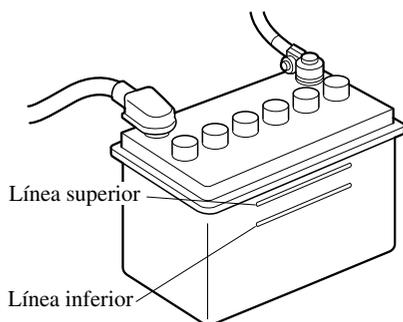
Inspeccione el nivel del electrolito al menos una vez a la semana. Si está bajo, retire la tapa y agregue suficiente agua destilada para llevar el nivel entre las líneas superior e inferior (consulte la figura).
