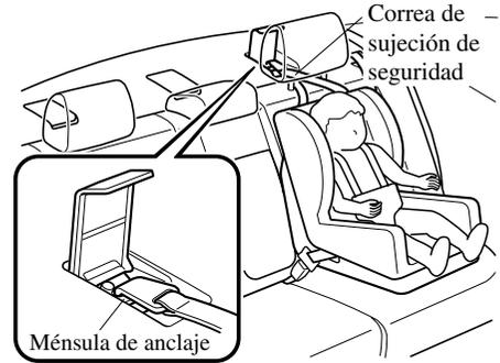
**Modelo con compuerta trasera Ubicación de la ménsula de anclaje**
