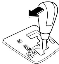
Para volver al modo selectora automático, mueva la palanca desde M a D.
