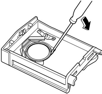
5. Coloque la pila nueva (CR1620 o equivalente) con el polo positivo (+) hacia abajo.
