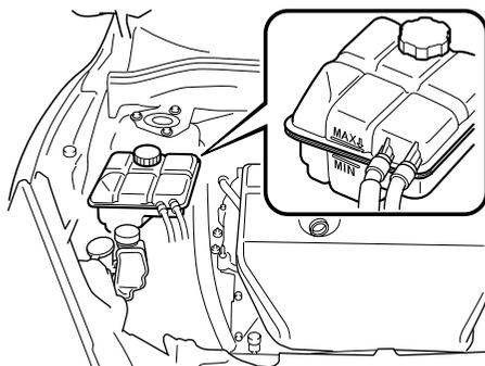
Si está en o cerca de la marca MIN, agregue suficiente refrigerante anticongelante y anticorrosivo en el depósito de refrigerante para llevar el nivel hasta la marca MAX.
