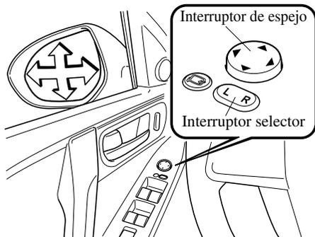
Después de ajustar el espejo, bloquee el control colocando el interruptor selector en la posición central.
