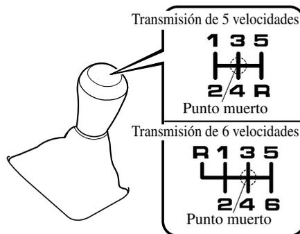
El vehículo está equipado con una transmisión manual de 5 o 6 velocidades. Anteriormente se indica el patrón de cambio para cada una.
