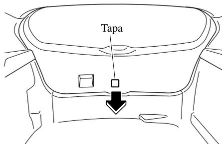
2. Gire la palanca hacia la derecha para abrir el seguro de la compuerta trasera.
