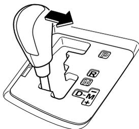
Para volver al modo selectora automático, mueva la palanca desde M a D.
