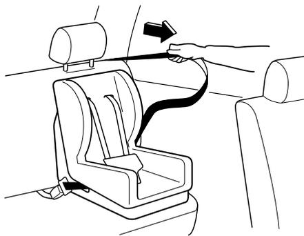
5. Empuje el sistema de seguridad para niños firmemente en el asiento del vehículo. Asegúrese que el cinturón lo apriete bien. Podrá oír ruidos provenientes del retractor al funcionar si el sistema se encuentra en el modo de bloqueo automático. Si el cinturón no sostiene el asiento bien seguro, repita este procedimiento.
