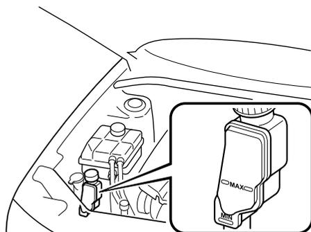
El nivel debe mantenerse entre las marcas MIN y MAX.
