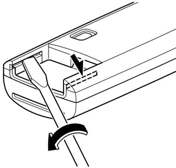
3. Inserte el destornillador de punta plana en la separación entre la cubierta y el transmisor, y luego gire el destornillador para retirar la cubierta.
