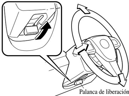
2. Incline el volante y/o ajuste el largo de la columna del volante a la posición deseada, empuje la palanca hacia abajo para bloquear la columna.
