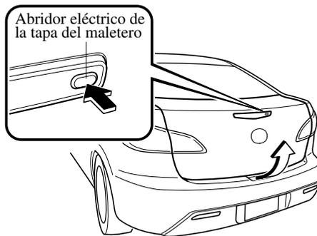
Mientras el encendido se encuentra en ON, la compuerta trasera/tapa del maletero se puede abrir solamente cuando se para el vehículo con el freno de mano aplicado (transmisión manual), o con la palanca selectora en la posición P (transmisión automática).
