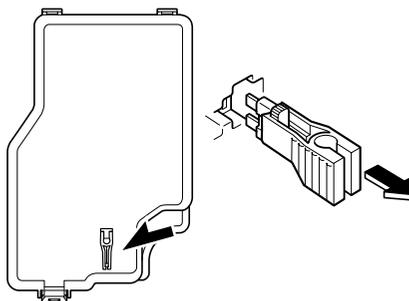
4. Inspeccione el fusible y cámbielo si está fundido.
