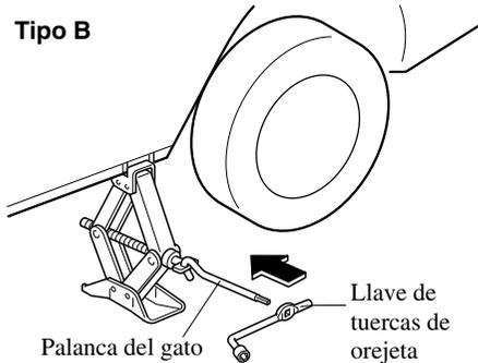
5. Gírela la manija del gato hacia la derecha y levante el vehículo lo suficientemente alto como para instalar el neumático de repuesto. Antes de quitar las tuercas de orejeta, verifique que el vehículo se encuentre en una posición estable y que no se deslice o mueva.
