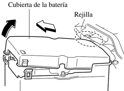
**Instalación de la cubierta de la batería**
