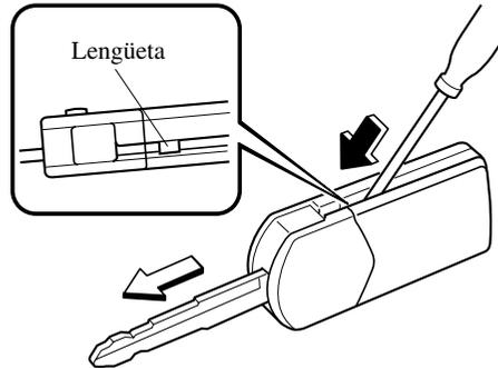
3. Inserte un destornillador en la ranura y haga palanca suavemente para abrir el transmisor.
