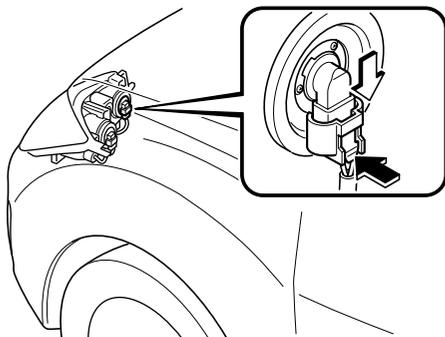
3. Gire el conector y el conjunto de la bombilla para desmontarla. Desmonte cuidadosamente la bombilla de su conector en el reflector tirando suavemente derecho hacia atrás del conector.
