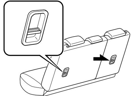
**Modelo con compuerta trasera Posición de la correa de sujeción**
