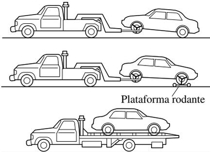
Cuando se remolca el vehículo con las ruedas traseras apoyadas en el suelo, se debe soltar el freno de mano.
