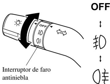
Para apagar el fero antiniebla delantero, gire el interruptor de faros antiniebla a la posición OFF o gire el interruptor de faros a la posición OFF.
