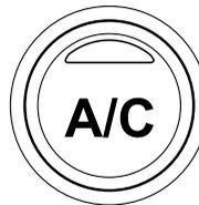
Oprima el interruptor A/C para conectar el acondicionador de aire. El indicador en el interruptor se encenderá cuando el dial de control del ventilador se ajuste a la posición 1, 2, 3 o 4.
