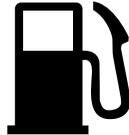
Esta luz de advertencia en el medidor de combustible indica que el tanque de combustible pronto quedará vacío. Agregue combustible tan pronto como sea posible.
