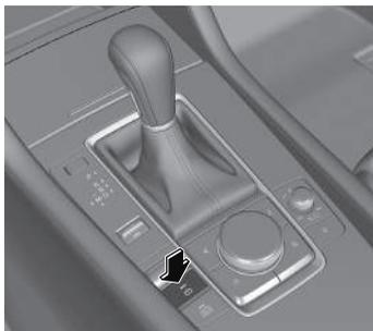
Si el interruptor del EPB se presiona sin pisar el pedal del freno, se muestra un mensaje en el visualizador de datos múltiples para notificar al conductor que debe pisar el pedal del freno.
