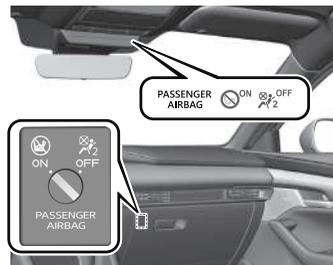
El interruptor de desactivación del airbag del pasajero debe ser usado para desactivar el airbag del pasajero y los airbags laterales, así como el sistema de pretensores del cinturón de seguridad del asiento del pasajero si se instala un sistema de seguridad para niños en el asiento del pasajero.
