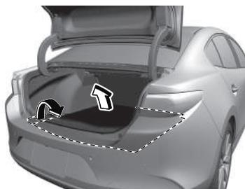
2. Gire el perno de sujeción del neumático de repuesto hacia la izquierda y desmonte el neumático de repuesto.
