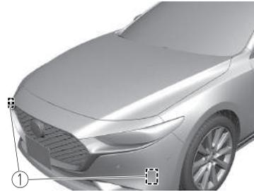
1. Sensor de radar lateral delantero
