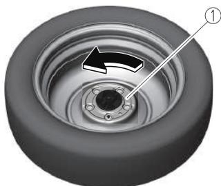
1. Perno de sujeción del neumático de repuesto
