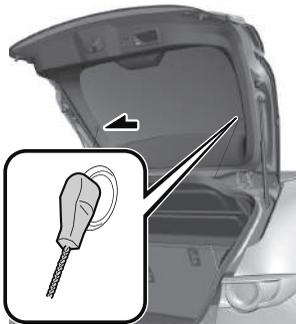
**Retirada de la cubierta del compartimiento para equipajes**
