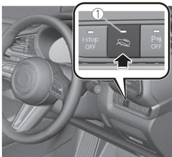
1. Indicador visual del interruptor del sistema de asistencia para tracción todo terreno
