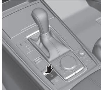
Si el interruptor del EPB se presiona sin pisar el pedal del freno, se muestra un mensaje en el visualizador de datos múltiples para notificar al conductor que debe pisar el pedal del freno. Consulte la sección Mensaje indicado en el visualizador de datos múltiples en la página 7-73.
